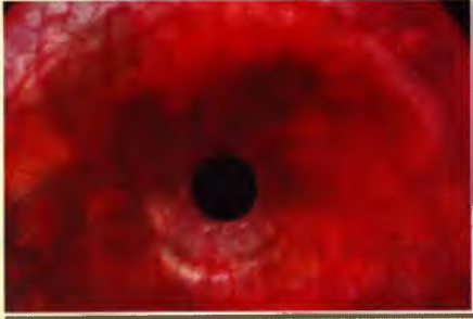
ပုံ (၁-၁) ဆေးဆိုးထားသောကျောက်စိမ်းကို အဆချဲ့အကျွတ်ရိယာဖြင့် ကြည့်ရှုစစ်ဆေးပါက ယမ်းလုံးယမ်းစတ်များစို့၏ ပတ်ပတ်လည်ရှိ နေရာလွတ်နေရာများနှင့် အက်ကြောင်းများထဲ၌ ဆိုးဆေးများ စုပုံနေသည်ကို တွေ့နိုင်ပါသည်။
