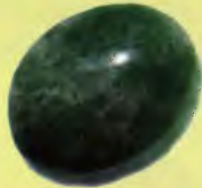
ပုံ (၁-၄) ရေချိုးကျောက်(B)ကို ကားဆိုး(C)ပြီး နှစ်ချိုးနှစ်ပုံပြုပြင်ထားသည့် (B+C)ကျောက်မီးစက် နေပြင်တော်တွင် (၆)လမျှနေထိုင်ခဲ့ပြီးနောက် ခွဲသားကြမ်းပြီး အက်ဆာအနာပျားငယ်လာကာ မူလအသားပုံ ပျက်ယွင်းသွားသည်ကို တင်တင်စားစားတွေ့မြင်နိုင်သည်။
